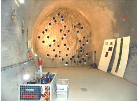
Bohrungen für Messversuche
